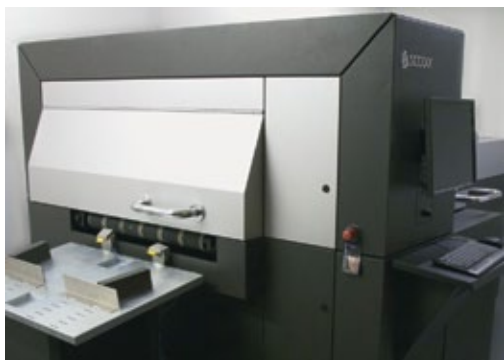
Die Scodix-Sprintlack-Maschine S 74 bei Rieker Druckveredelung arbeitet mit einem integralen Pass- und Registersystem.
